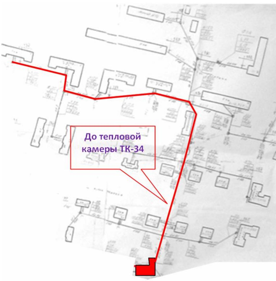
Рисунок Вероятность безотказной работы тепловых сетей от котельной до ТК-34
