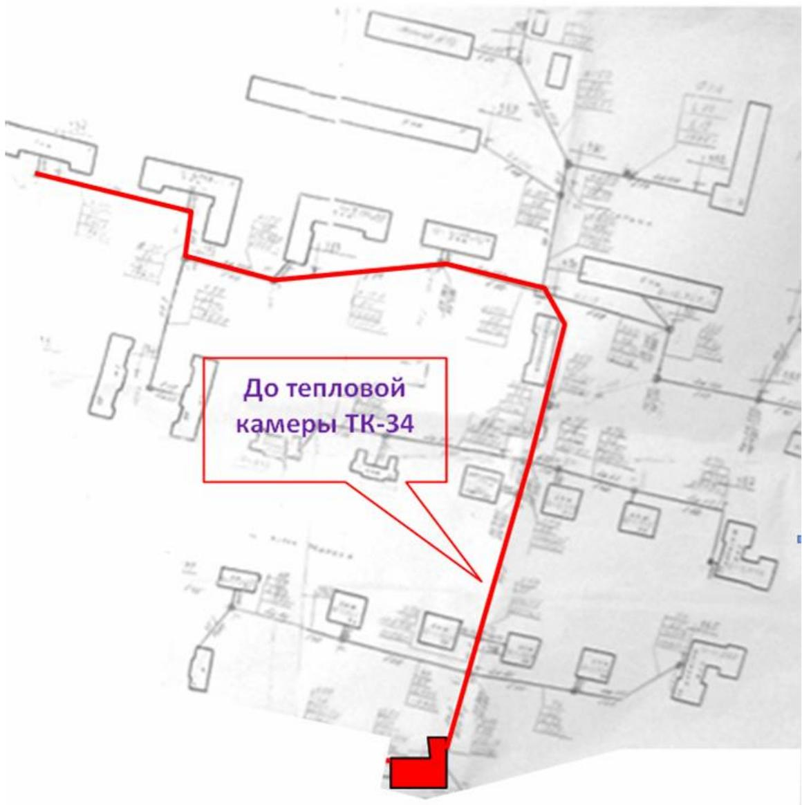
Рисунок Путь гидравлического расчёта тепловых сетей от котельной «Центральная» до ТК 34
