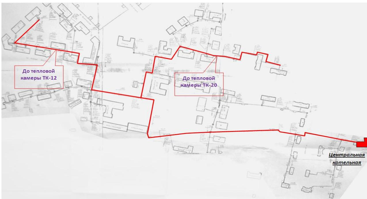
Рисунок. Пути гидравлического расчёта тепловых сетей от котельной «Центральная»
